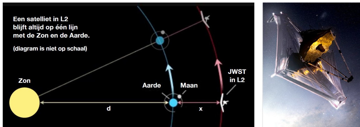
Figuur 7. De James Webb Space Telescope is ‘geparkeerd’ in Lagrange-punt L2 op afstand x van de aarde en houdt het zonnescild altijd naar de aarde en zon gericht.
